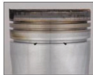
Stempelrings-zonen efter 8824 timers drift og op til 3052 timer mellem olieskifteintervallerne
